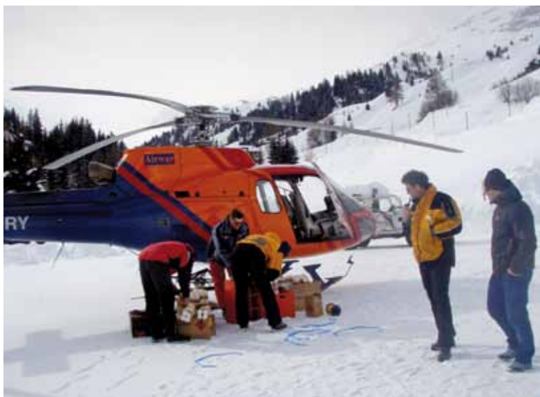
Fig. 9 Operazioni di imbarco delle cariche di esplosivo su elicottero prima delle operazioni di distacco artificiale
