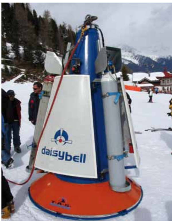
Fig. 10 Il sistema di distacco artificiale delle valanghe Daesy Bell
