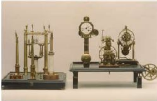
Fig. 1 - Sismografo elettromagnetico di Luigi Palmieri. A sinistra il sensore, costituito da 5 diversi sismoscopi; a destra sistema del tempo e apparato per la registrazione su carta. Costruito da G. Bandieri, Napoli 1856 (Museo Osservatorio Vesuviano, Ercolano, Napoli).
