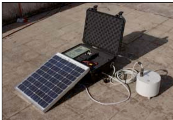
Figura 1. Stazione sismica mobile Nanometrics Taurus, alloggiata all'interno di una valigetta Peli, con relativo sensore Lennartz LE-3D 20s.
