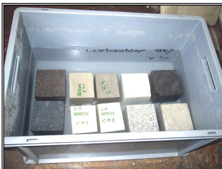
Fig.9 – Provini in saturazione. Tutti i campioni da testare in saturazione d'acqua dolce o salata sono stati saturati, pesati e mantenuti in saturazione per almeno una settimana prima della prova di rottura.
