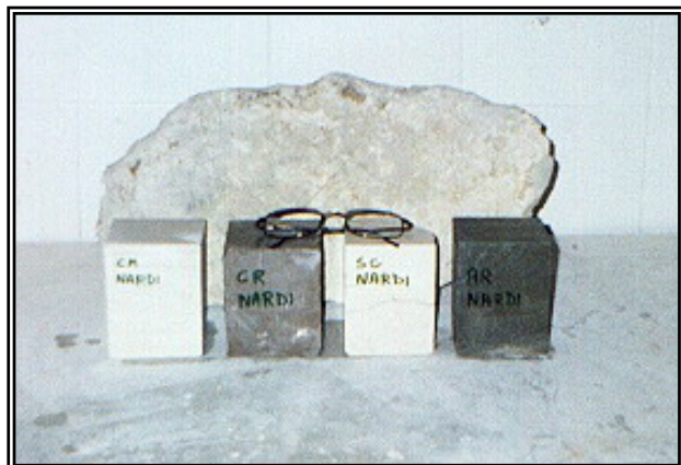
Fig.3 – Campioni rappresentativi delle quattro litologie confrontati con un blocco grezzo. Le dimensioni dei provini sono 8x8x10 cm.
