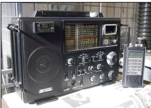
Fig.22 - La strumentazione di monitoraggio delle prove di rottura: a) Radiogeofono. b) Ricevitore HF. c) Scanner UHF. d) Microfono preamplificato. e) Estensimetro.
