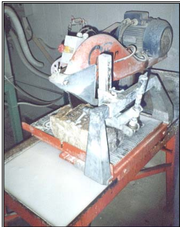
Fig.2 – Taglio dei blocchi (laboratorio DST). Da ciascun blocco si è ricavato più di un campione, tagliato in forma di parallelepipedo con una particolare cura nel parallelismo.
