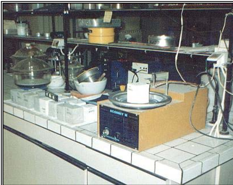
Fig.5 – La smerigliatrice (laboratorio FS). Le basi minori di ciascun campione sono state levigate con carta abrasiva a grana finissima per assicurare la massima aderenza alle piastre della pressa.
