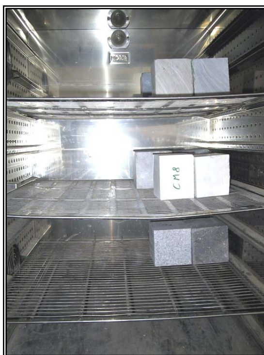
Fig.8 – Provini nel forno. Per rilevarne il peso secco, i campioni destinati alle prove sature sono stati tenuti per 24 ore in un forno ventilato a 110°C.
