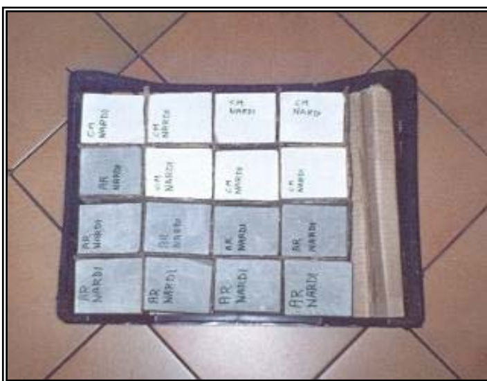
Fig.6 – Campioni pronti per le prove di rottura. Sono stati lavorati in totale 32 provini.
