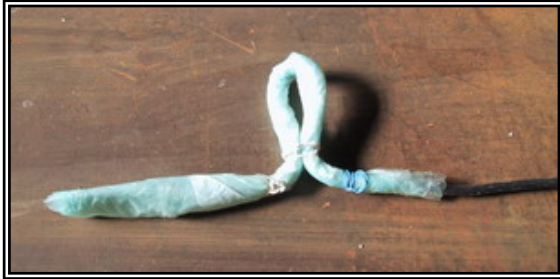
Fig. 24 - La sonda avvolta nel sacchetto da freezer per l'impiego in acqua. L'ansa aiuta ad impedire l'ingresso dell'acqua.
