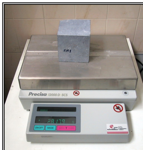
Fig.7 – Bilancia elettronica centesimale per la pesatura dei provini. Sui campioni da impiegare nelle prove in saturazione sono stati misurati i pesi naturale, secco e saturo.
