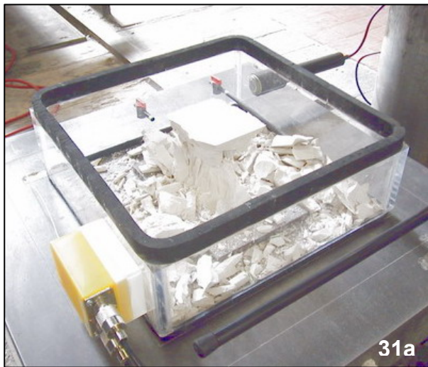
Fig.31 – Prove di rottura: a) residui del provino dopo la rottura b) rottura “a clessidra” c) rottura “a morsa”
