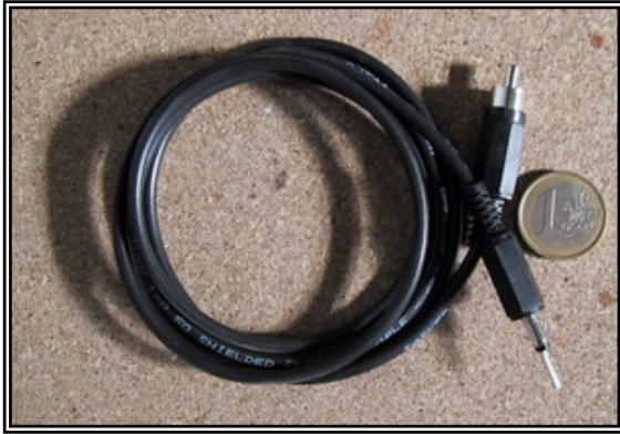
Fig. 23 - Il cavetto-sonda usato con la sorgente artificiale. Il dipolo emettitore (in basso nella foto) è ricavato da un jack forato (del tipo solitamente usato negli alimentatori).
