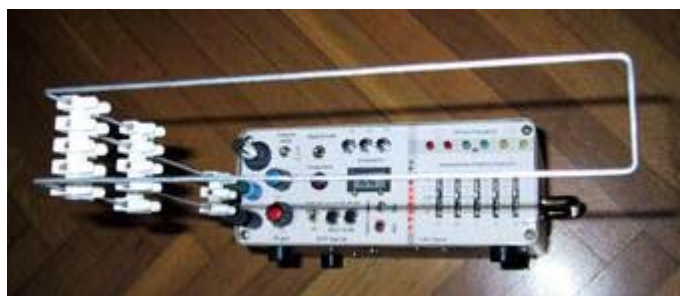
Fig.45 - Sonda elettrica del campo E-VLF montata sul ricevitore
