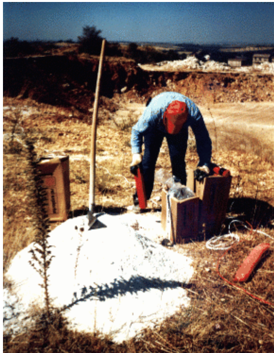
Fig.25 - L'artificiere riempie un pozzo con l'esplosivo
