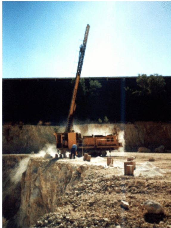
Fig.26 - Perforatrice e artificiere a lavoro sul fronte della cava. Ogni scatola di cartone corrisponde ad un pozzo minato
