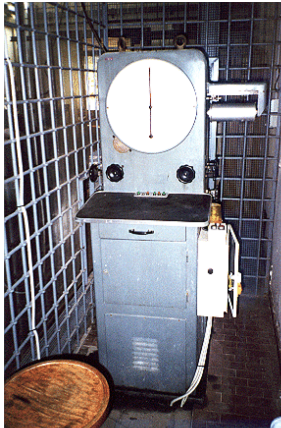
Fig.50 - La consolle di comando della pressa è racchiusa in un'area di sicurezza dove tutto il personale deve essere confinato durante il funzionamento della macchina.
