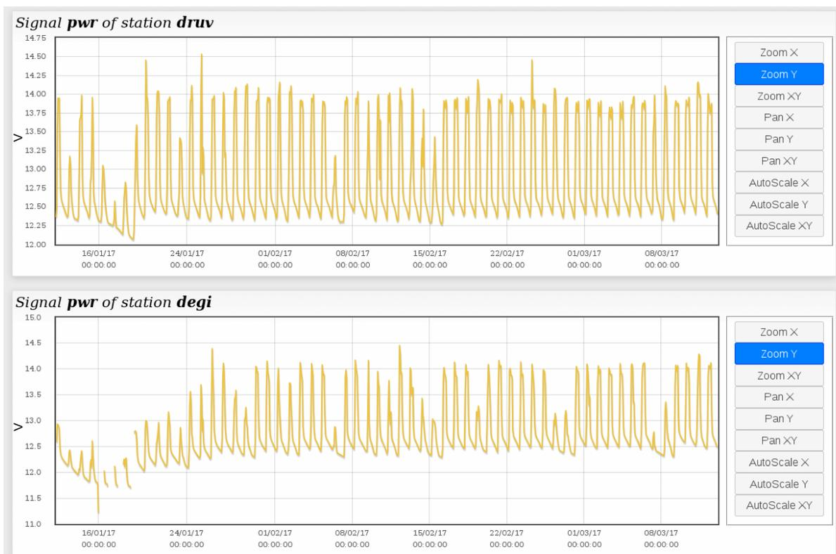
**Figura 6.** Rappresentazione grafica dei segnali acquisiti, organizzati per tipologia, al fine di facilitare il confronto dello stesso segnale in siti diversi. Il segnale rappresenta gli ultimi 60 giorni della tensione di batteria acquisita nei due siti etnei DRUV (M.te Ruvolo) e DEGI (M.te Egitto).
