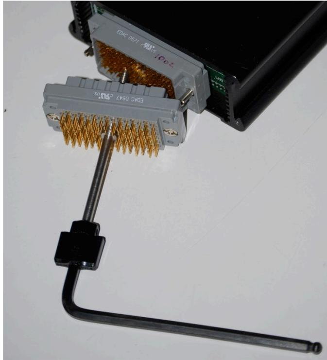
**Figura 4.** Esempio di connettore con estrattore a chiave esagonale.
