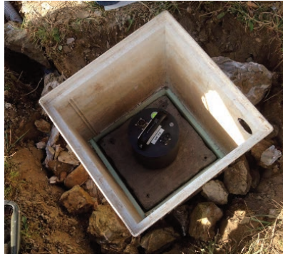
Figura 5 Posizionamento del sensore sulla mattonella di cemento.
