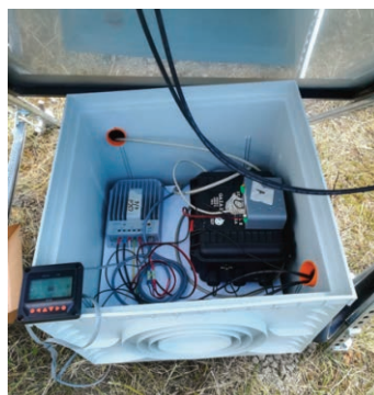
Figura 11 Pozzetto completo di digitalizzatore GAIA2, router Advantech UR5i e regolatore di carica Epever Tracer 1215BN.
