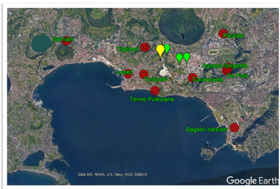
Figura 4.16 - Ubicazione dei punti di misura e campionamento delle acque di falda relativi alla campagna del 2020, con il simbolo rosso sono riportati i siti della rete di monitoraggio multiparametrico in continuo della falda. In giallo la prima stazione equipaggiata con i nuovi sensori HT (fino a 100 °C).
