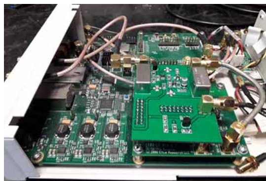
Figura 11 Il dispositivo SDR N210 con il ricevitore montato (in primo piano). Più sotto vi sono la scheda madre e le schede daughter board Tx e Rx.
