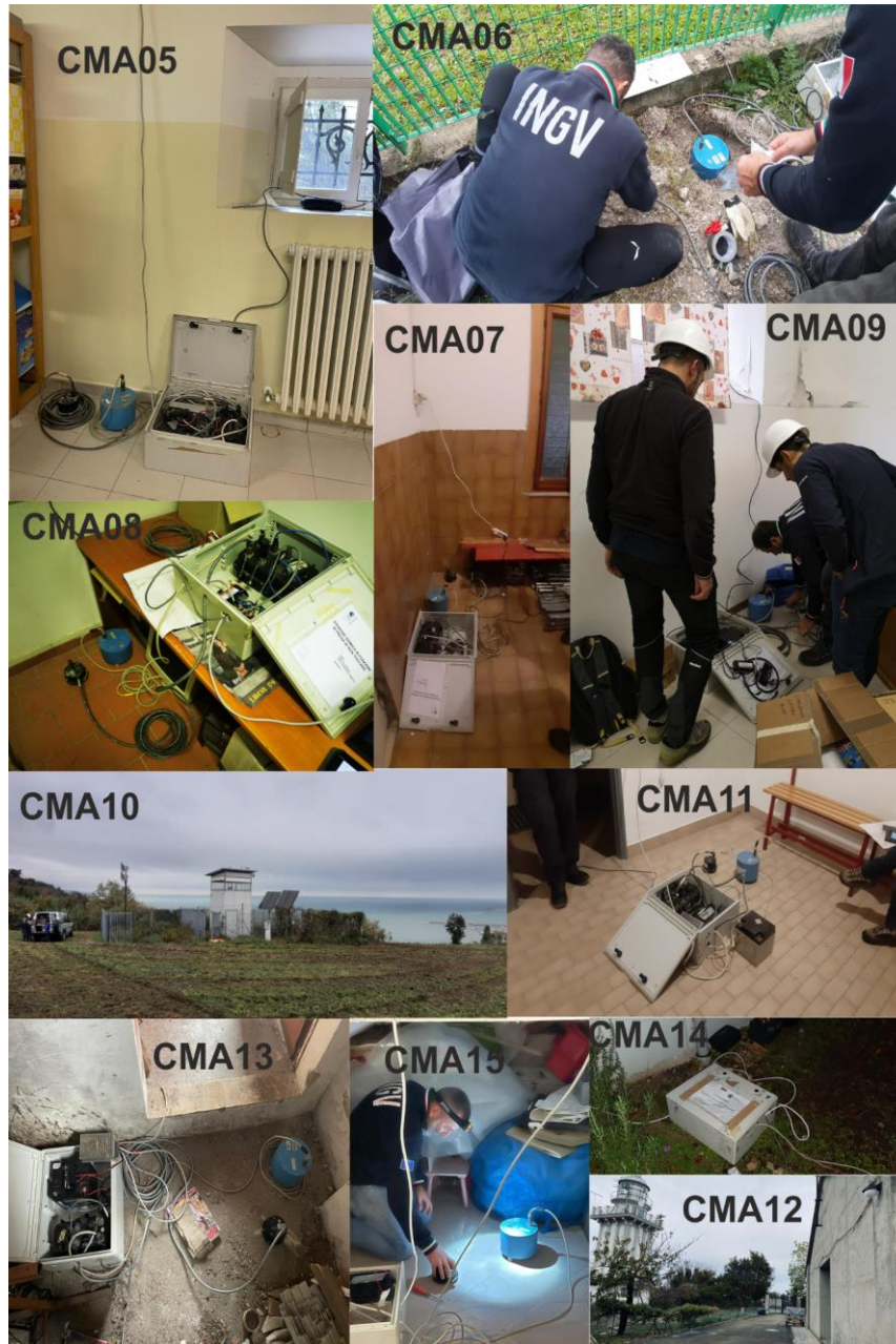
Figura 2.1. Foto dei siti ospitanti le 11 stazioni sismiche (da CMA05 a CMA15) con alcuni dettagli sulla strumentazione utilizzata, la tipologia di terreno su cui poggiano i sensori e le operazioni di installazione da parte del personale di EMERSITO.
