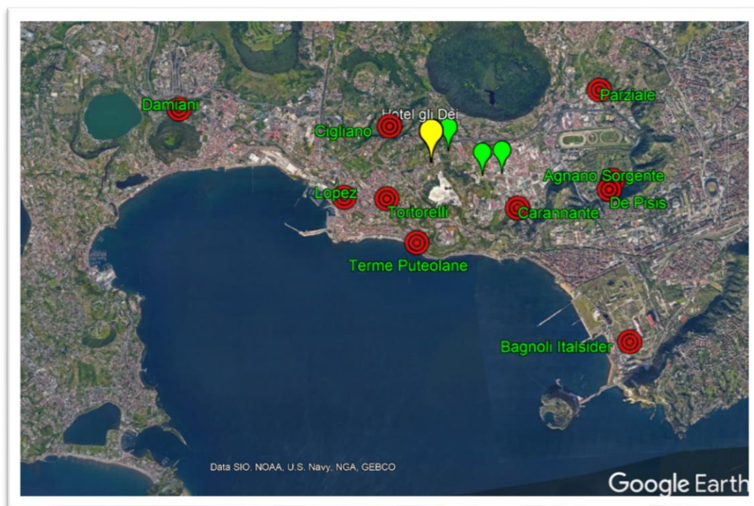
Figura 4.17 - Ubicazione dei punti di misura e campionamento delle acque di falda relativi alla campagna del 2020, con il simbolo rosso sono riportati i siti della rete di monitoraggio multiparametrico in continuo della falda. In giallo la prima stazione equipaggiata con i nuovi sensori HT (fino a 100 °C).
