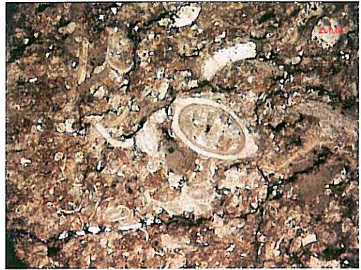
TCC1: packstone bituminoso la cui frazione granulare è costituita principalmente da foraminiferi planctonici e resti di echinidi. Subordinata è la presenza di microforaminiferi bentonici (rotaliidi e textulariidi), ditrupe (nella foto), frammenti di molluschi, noduli e frammenti di alghe rosse. Sono diffusi fenomeni di fosfatizzazione e glauconitizzazione tipici delle facies di tetto della formazione. Età: Tortoniano superiore
