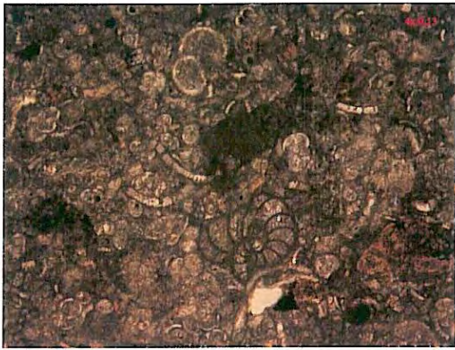
CPPL: emipelagite a tessitura wackestone-packstone, glauconitica; in esso sono presenti globigerine prevalenti, Globoquadrina e rare globorotalie; il dettaglio la copresenza di foraminiferi bentonici e planctonici. Età: Aquitaniano-Langhiano.
