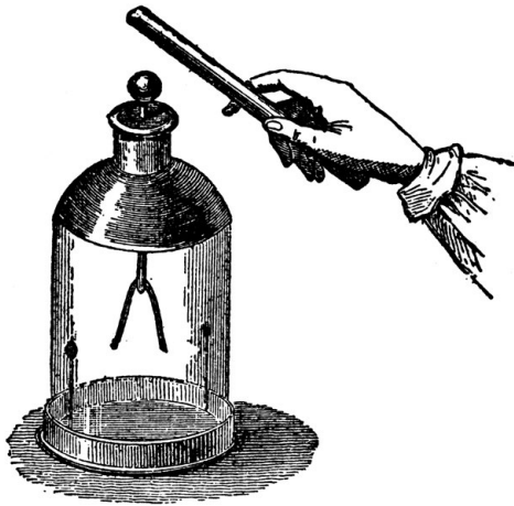
Figura 2 Elettroscopio Bennet (1780) a fogli di alluminio. È lo stesso tipo di strumento con cui Humboldt osservò la presenza di elettricità statica nell'aria durante un terremoto a Cumaná (Venezuela).
