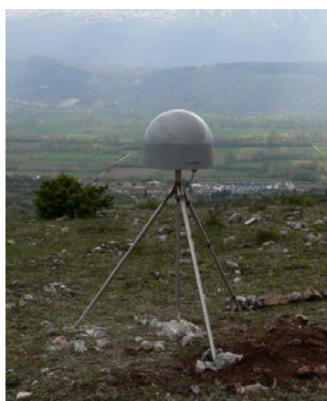
Figura 3 Tipica installazione dell'antenna geodetica su tripode in acciaio della rete RING.
