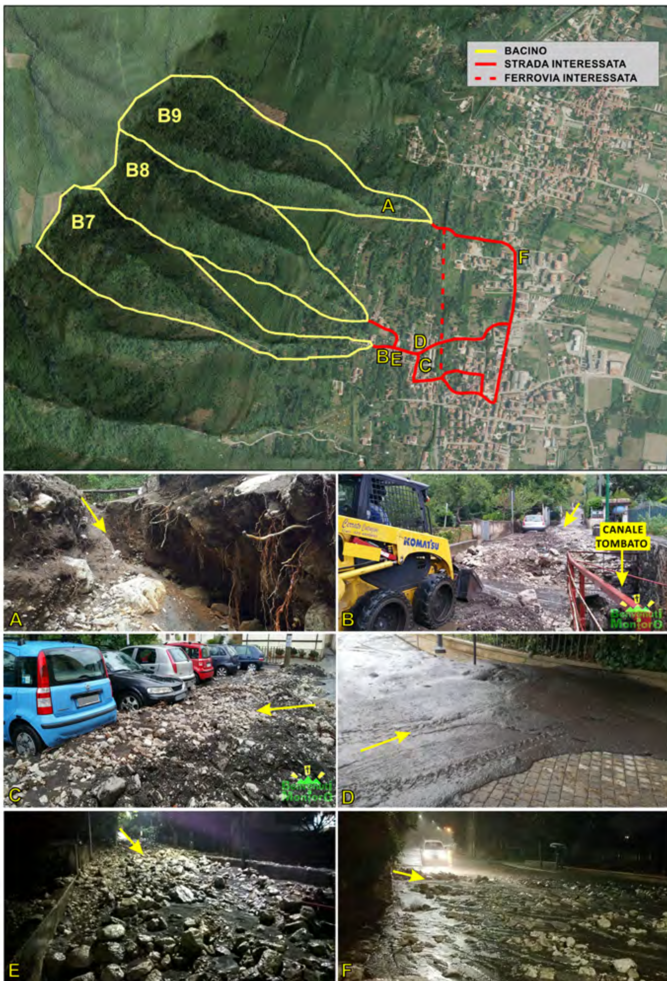
Figura 7. Panoramica dei bacini idrografici e dell'area urbanizzata interessata dall'invasione di flussi fangoso-detrifici. Le immagini pubblicate dalla pagina Facebook "Benvenuti a Montoro" rappresentano l'erosione di un canale (A), ed i depositi di fango e detrito rinvenuti lungo le strade durante i diversi eventi (B,C,D,E,F)
