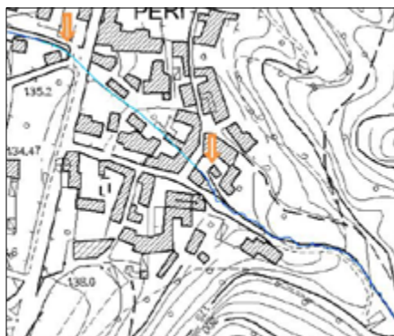
Figura 2. Conoide su cui sorge l'abitato di Peri. Le frecce indicano l'inizio e la fine della condotta interrata sotto la frazione
