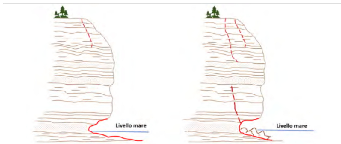
Figura 4. Condizioni progressivamente più instabili dovute al moto ondoso in presenza di solco di battente alla base della falesia e la formazione di una frattura subverticale dovuta all'azione marina sia meccanica che chimica. La presenza di fratture di tensione nella parte superiore della parete indebolisce ancora di più il versante
