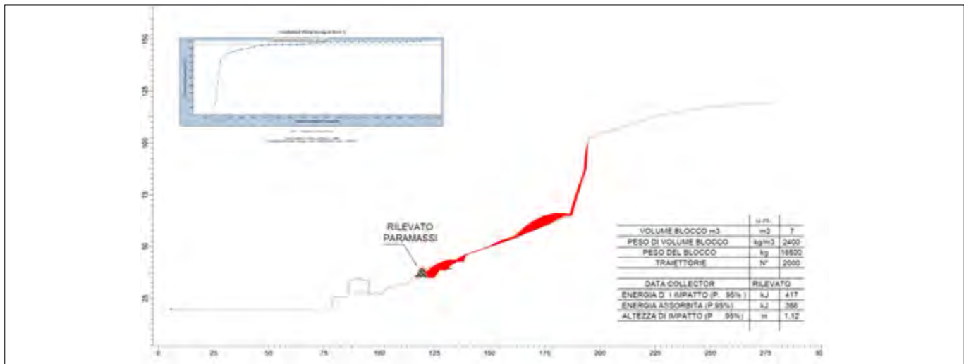
Figura 10. Simulazione caduta massi (Software RocFall) - Mappa Fs locale Versante-Barriera (Software SSAP-2018)
