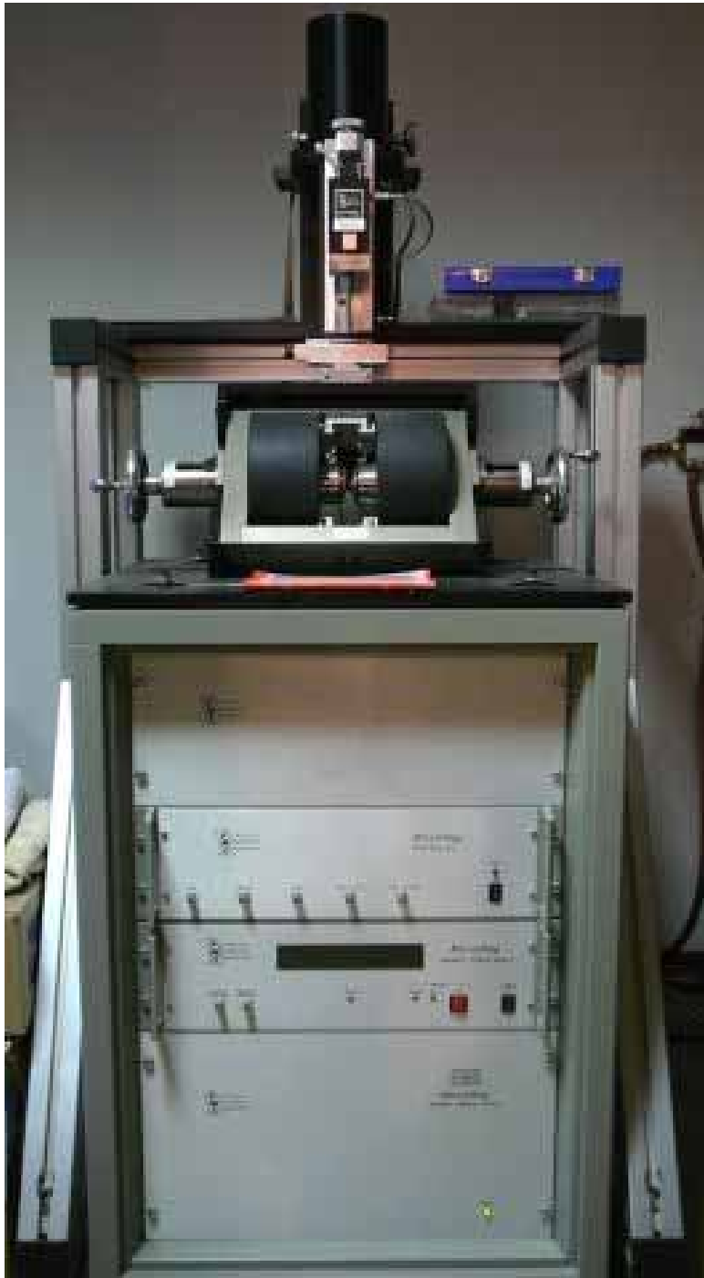
Figura 18 Strumento Micromag per la misurazione delle caratteristiche d'isteresi magnetica.
