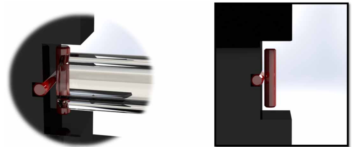
Figura 7 Due prospettive del rendering dei rullini SKF nella parte inferiore del sismometro.
