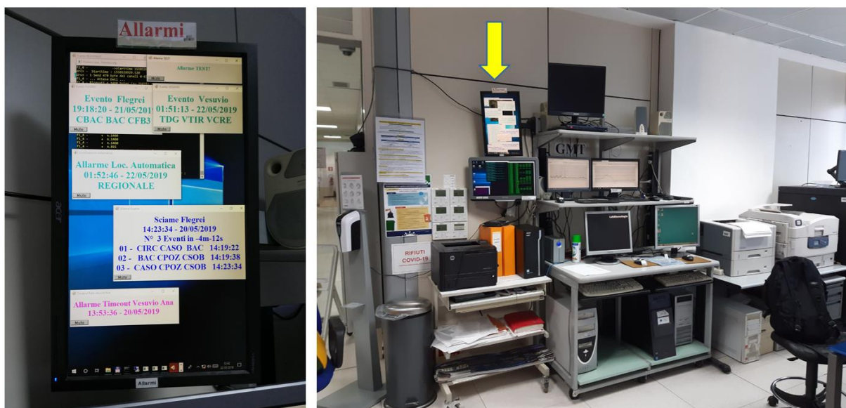
Figura 3: Monitor Allarmi e Post-it digitali. Nella foto a sinistra è possibile osservare il dettaglio del Monitor Allarmi e dei suoi Post-it digitali, a destra si può individuare la sua posizione nella Sala di Monitoraggio.
