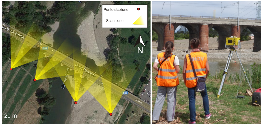
Figura 9. Schema del rilievo eseguito in data 19 agosto 2015 e foto scattata durante la fase di scansione. I cerchi rossi indicano il punto su mappa su cui ha stazionato lo scanner durante le misure. In giallo il campo di scansione.
