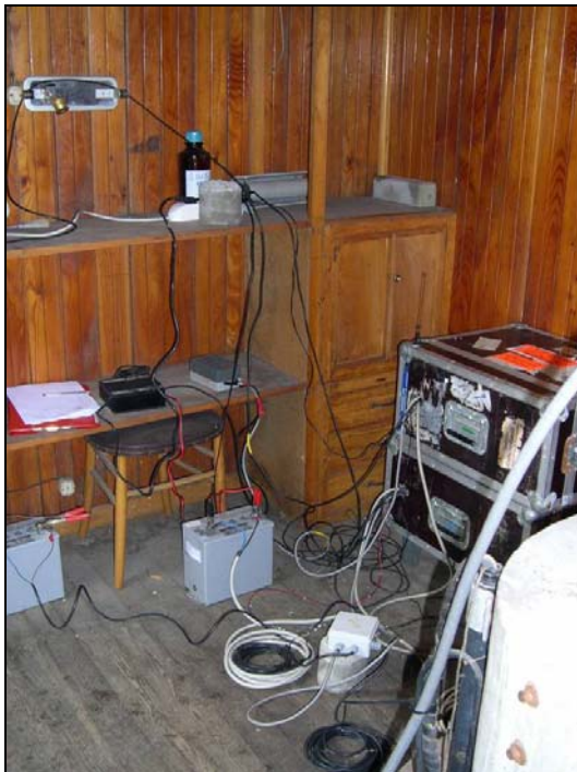
Figura 2 - Esempio installazione stazione accelerometrica e velocimetrica per il sito MER2 (Merate).
