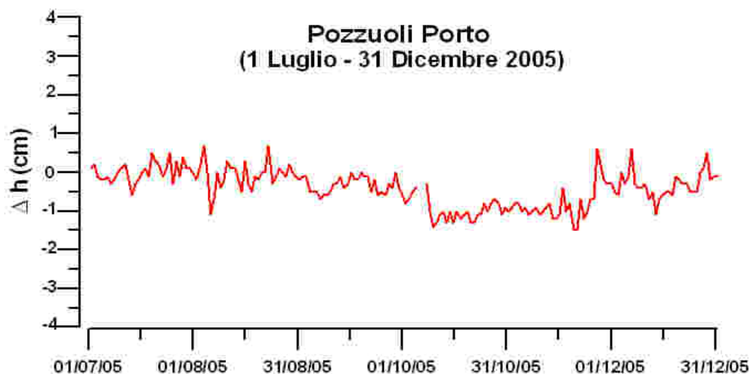
Figura 96 - Movimenti verticali del suolo ottenuti dall'analisi dei dati acquisiti dal sensore digitale alla stazione mareografica di Pozzuoli Porto. Le variazioni riportate rappresentano le medie giornaliere e sono riferite alla stazione di riferimento Napoli Porto.
