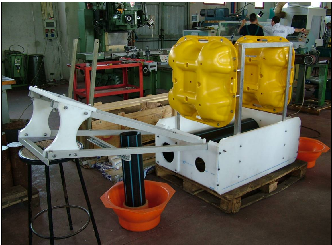
Figura 11 - Foto del prototipo di stazione da fondo mare (OBS) realizzata presso l'Osservatorio di Gibilmanna (Palermo) del Centro Nazionale Terremoti per lo studio dei terremoti nelle aree marine e costiere. Nel corso del 2006 verranno effettuati i primi test delle 4 stazioni realizzate.
