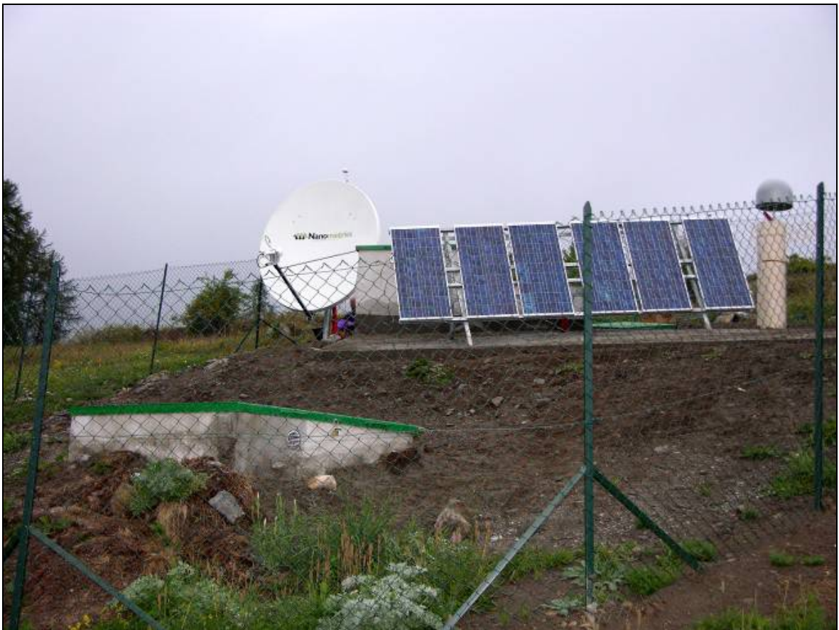
Figura 16 - Stazione integrata sismica e GPS con trasmissione satellitare Nanometrics.
