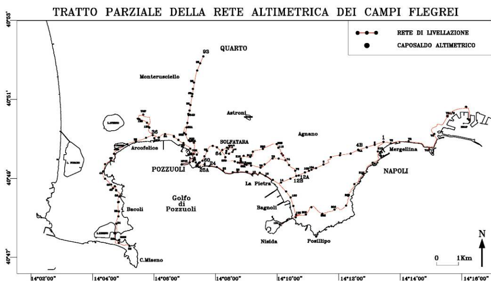
Figura 40 - Parte della Rete Altimetrica dei C.Flegrei interessata dalle misurazioni di Ottobre 2005.
