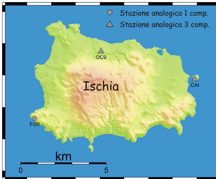
Figura 20 – Dettaglio della rete sismica di Ischia.
