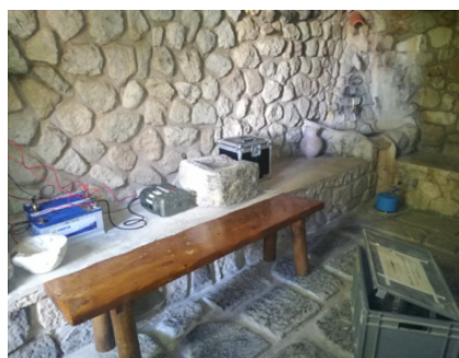
Figura 3 Stazione sismica T1367 equipaggiata con acquisitore Gilda e sensore LE3D5s Lennartz. L'apparato strumentale è alimentato con 2 pannelli solari da 100 W ciascuno.
