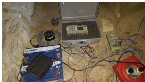
Figura 2 Stazione sismica T1366 equipaggiata con Taurus Nanometrics a 6 canali con sensore a corto periodo LE3Dlite Lennartz e accelerometro Episensor FBA-EST Kinematics.
