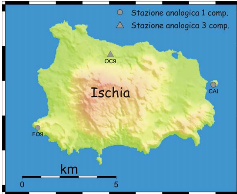
Fig.14: Dettaglio della rete sismica di Ischia.
