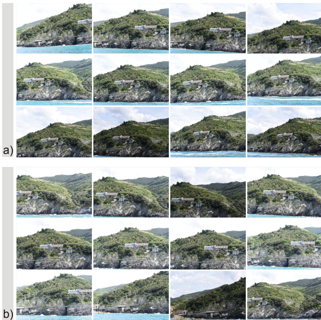
Figura 4. I set di immagini selezionate per la restituzione fotogrammetrica del rilievo dell'area test. a) 12 immagini relative alla prima campagna di misura (SfM1); b) 12 immagini relative alla seconda campagna di misura (SfM2).
