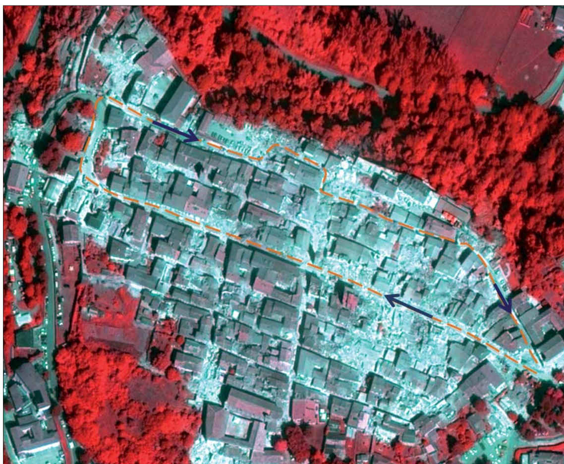
Figura 13 – Immagini Pleiades del centro storico di Amatrice (grid: 10m): dettaglio delle aree occupate dalle macerie e dai diversi tipi di edifici crollati. (AIRBUS Defence & Space)
