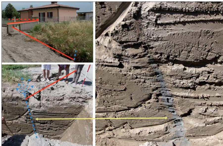
Figura 15 – Frazione San Carlo – trincea scavata dal Dipartimento della protezione civile a Via Rossini. La trincea è trasversale alle fratture dalle quali sono fuoriuscite le sabbie a seguito della liquefazione. In rosso e in azzurro l'andamento, rispettivamente, in superficie e in profondità delle fratture
