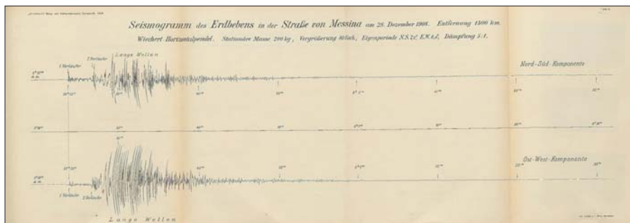
Figura 1. Sismogrammi del terremoto del 1908 registrati alla stazione sismica di Göttingen, Germania (Mintrop, 1909)
