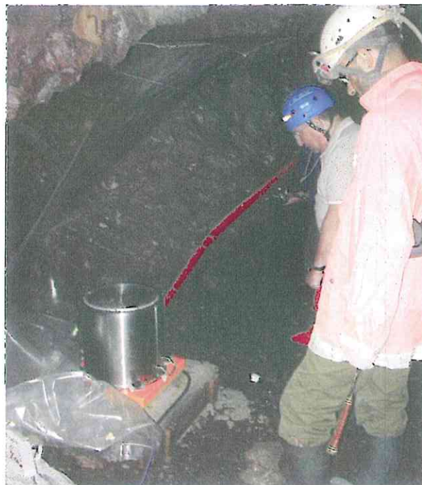
Fig. 14: il sismometro schermato nell'ipogeo di Maissana (SP) (foto M. Cattaneo). Fig. 14: shielded seismometer in the Maissana (La Spezia) underground cavity (photo M. Cattaneo).
