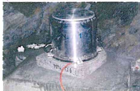
Fig. 6: il sismometro a Larga Banda STS2 in Val Ridanna prima (a sinistra) e dopo la schermatura classica in metallo e materiale isolante (a destra) (foto P. Casale).
