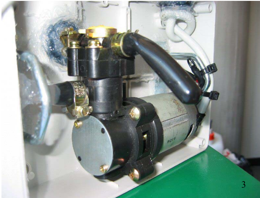
Fig.3. La pompa a 12 volt utilizzata per la pulizia del vetro.
