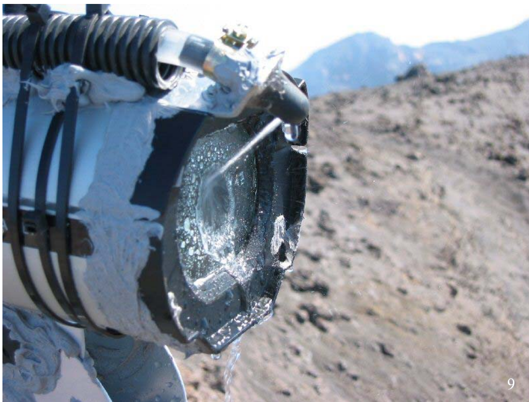
Fig. 9. La telecamera visibile con il sistema di pulizia vetro in funzione.
