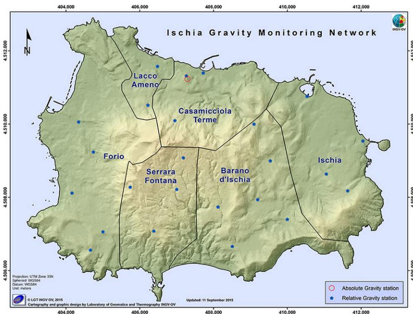
**Figura 2.3.1** - Vertici della rete gravimetrica dell'OV-INGV Isola d'Ischia ([www.ov.ingv.it](http://www.ov.ingv.it)). Il caposaldo assoluto di riferimento della rete è localizzato presso il complesso monumentale di Largo San Marcellino (Napoli) e non è riportato in mappa.
