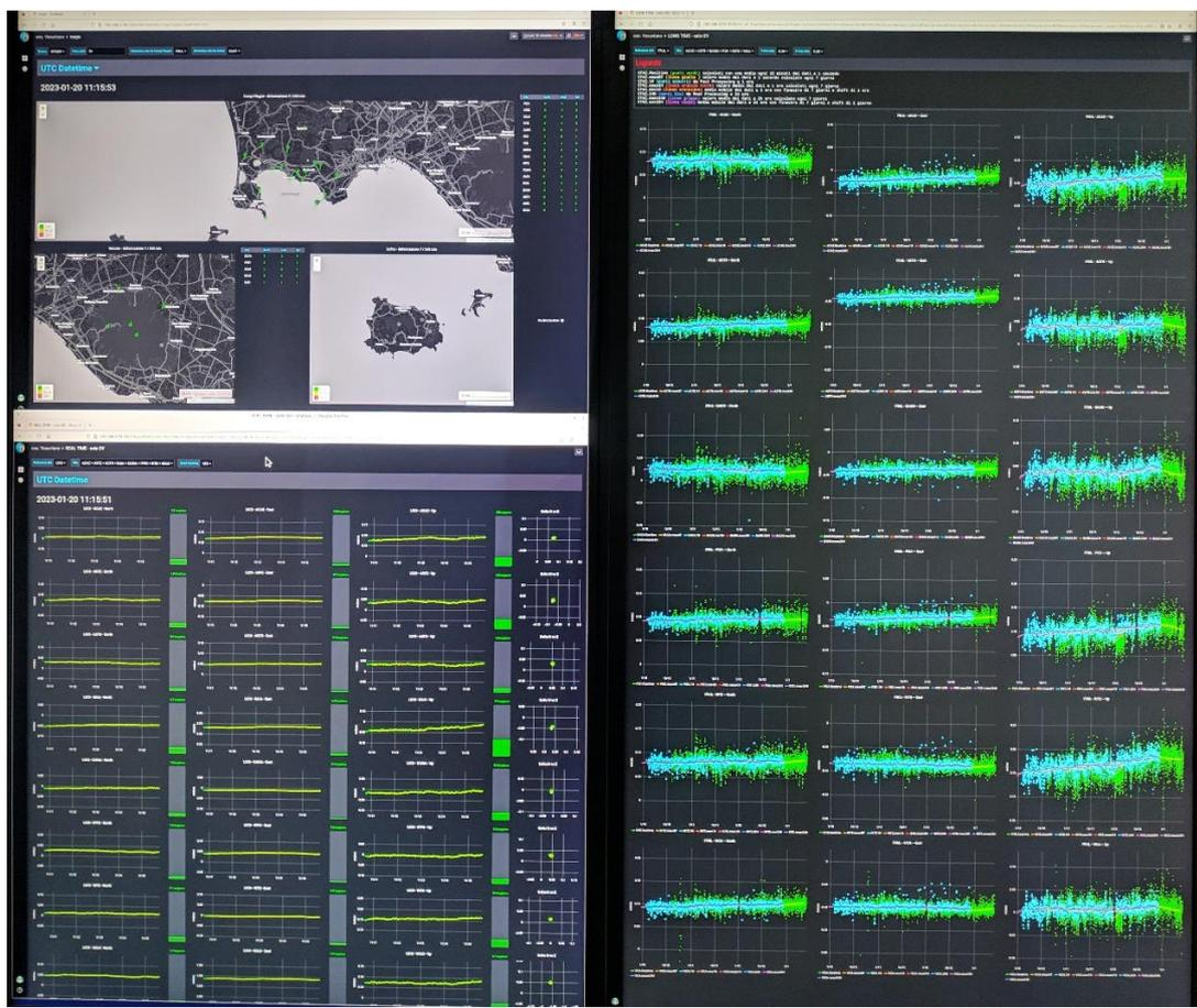
**Figura 2.1.2** - (RTView\_OV) Sistema di visualizzazione ed analisi in tempo reale dei dati GNSS ad alta frequenza (1 Hz) operativo in Sala di Monitoraggio.
