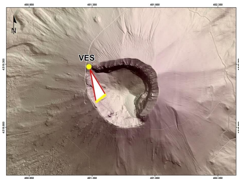
Figura 3.1.1 - Mappa della Rete Permanente di Monitoraggio Termico ad Immagine operante al Vesuvio.
