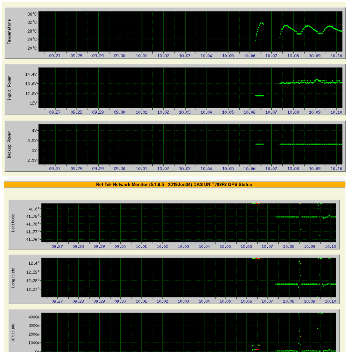
Figura 4. Visualizzazione dello State-of-Health per la stazione 98F8 (ubicata nell’Impianto ACEA). Dall’alto in basso si riportano i valori di temperatura, voltaggio batteria esterna e interna, latitudine, longitudine e altitudine.
