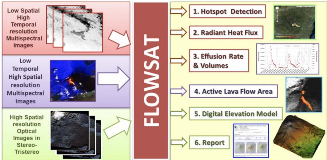
**Figura 1** Diagramma di flusso del sistema FLOWSAT. Il sistema è costituito da 6 moduli che forniscono i seguenti prodotti: (1) anomalie termiche; (ii) flusso radiante; (iii) tasso effusivo e volumi emessi, (iv) area del campo di lava attivo; (v) modello digitale della topografia e (vi) rapporto.
