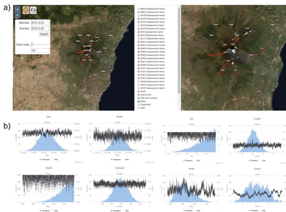
**Figura 1** Vista dell'uscita dello strumento sviluppato. Come mostrato nel riquadro sinistro di (a), il periodo viene scelto per calcolare il campo di deformazione, il riquadro destro mostra la posizione del dicco dopo l'inversione. (b) mostra le PDF dei parametri del modello di dicco per l'eruzione del 2018 all'Etna.
