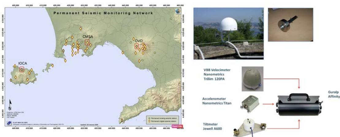
**Figura 1** A sinistra: la mappa dei siti scelti per Ischia (IOCA), Campi Flegrei (CMSA) e Vesuvio (OVO) evidenziati con un rettangolo rosso. A destra: in alto esempio di stazione GNSS da installare e in basso schema semplificato della stazione sismo/tiltmetrica.
