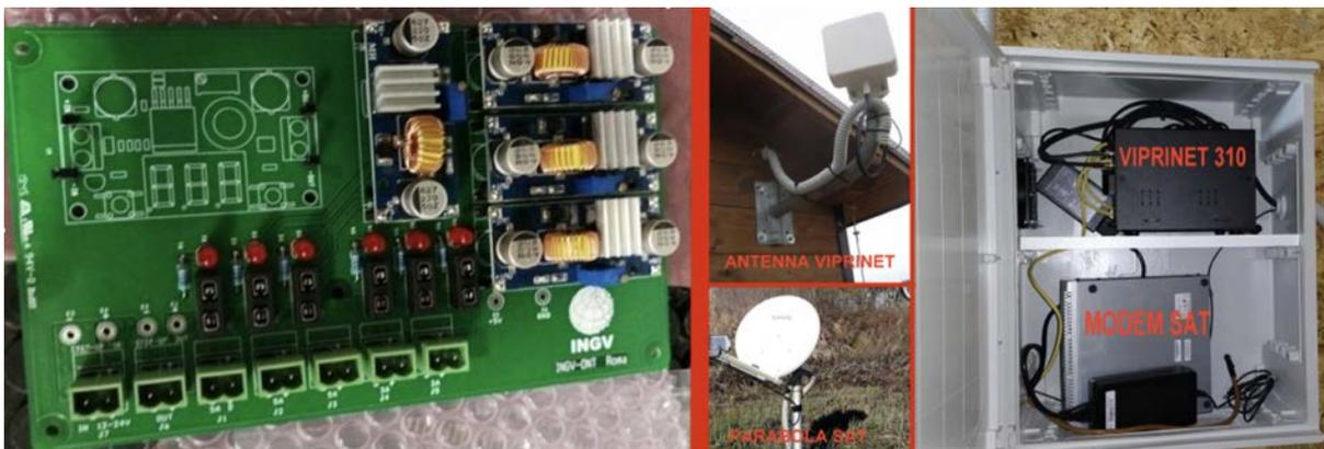
**Figura 3** A sinistra è visibile il modulo *switching* in grado di fornire il *back-up* dell'alimentazione di stazione. Al centro e a destra invece viene ritratto sistema di ridondanza di trasmissione realizzato presso la stazione di LATB (Latina).
