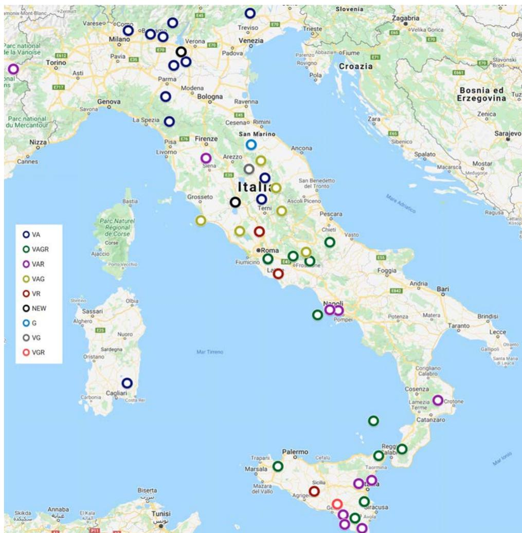
**Figura 1** Mappa della rete multiparametrica realizzata. Ogni colore rappresenta la presenza di determinati sensori. V = velocimetro, A = accelerometro, G = GPS geodetico, R = radonometro. “VAR” sta quindi ad indicare una stazione con presenza di velocimetro, accelerometro e radonometro. I nuovi siti invece sono indicati con “NEW” (cerchi in nero).
