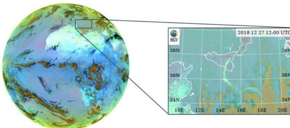
**Figura 2** Il *composite RGB* dell'interno emisfero visto dal satellite Meteosat-11 posto a  $0^\circ$  di longitudine. Il *composite RGB* è riferito ai dati acquisiti il 27 dicembre 2018 alle ore 12.00 UTC. Da esso si è creato un ritaglio in cui è visibile, in verde, sulla Sicilia meridionale, Malta e l'area centrale del Mediterraneo, la nube di  $\text{SO}_2$  emessa dal vulcano Etna.
