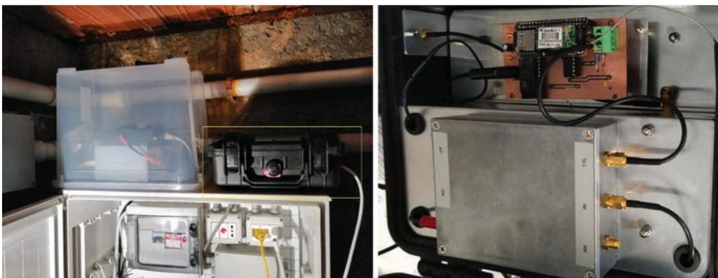
**Figura 3** Stazione sismica SRES installata nella *galleria-bunker* del Monte Soratte, montagna nella provincia di Roma, nel mezzo della valle del Tevere. La valigetta nera contiene il sensore radon e l'acquisitore. A destra viene mostrato l'interno della valigetta dove è visibile lo strumento Lucas Cell in telecontrollo (ved. Cannelli et al. [2020]).
