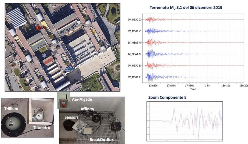
**Figura 2** Ubicazione e foto delle due stazioni utilizzate per la prova di rumore per il sito di CMSA (Campi Flegrei). A destra le tracce del terremoto registrato alle due stazioni. In blu la stazione MSA1 e in rosso la stazione MSA2.
