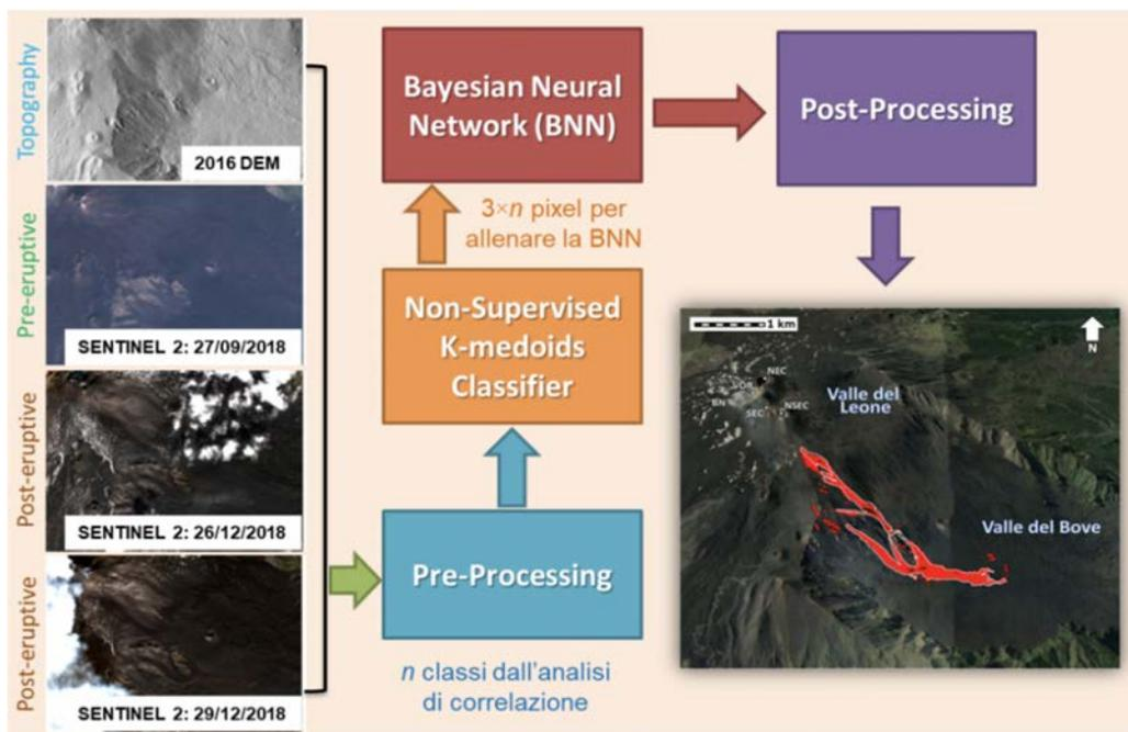
**Figura 2** Flusso di lavoro adottato per mappare i campi di lava basato sui dati topografici e sulle immagini di Sentinel-2 MSI. I dati di input vengono prima pre-elaborati e forniti come *input* al classificatore *k-medoide* non supervisionato; quindi *n pixel* per ogni classe vengono utilizzati per addestrare la BNN. Infine l'output della BNN viene post-elaborato ottenendo un'immagine con l'estensione areale della colata lavica [da Corradino et al., 2019].
