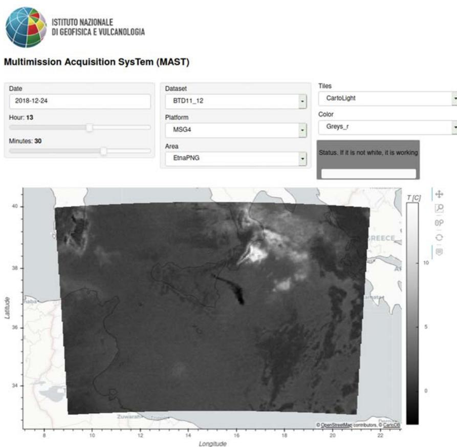
**Figura 3** *Front-End* grafico (GUI) da cui è possibile selezionare piattaforma, data, proiezione, visualizzare i dati satellitari e/o prodotti già salvati, o processarli al momento. In figura la BTM tra i canali a 11 e 12  $\mu\text{m}$  del sensore SEVIRI a bordo del satellite Meteosat-11 (MSG4). Area del Mediterraneo Centrale, giorno 24-12-2018 ore 13:30 UTC, visibile al centro immagine la nube di cenere emessa dall'Etna [Corradini et al., 2020].
