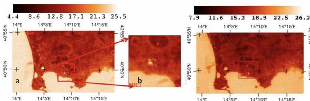
**Figura 2** Mappa di temperatura superficiale: a) ASTER acquisito alle 21.10 UTC del 17 ottobre 2019; b) particolare della temperatura ottenuta da ASTER sull'area della Solfatara; c) Landsat 8 acquisito alle 20.46 UTC del 18 ottobre 2019.
