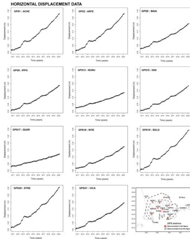
**Figura 1** Modulo dello spostamento orizzontale registrato in 1/2011-3/2020 in 11 stazioni GPS mappate nell'angolo in basso a destra (UTM 33T). Lo spostamento è misurato rispetto al giorno di messa in posto, ad es. nell'anno 2000 per i GPS 1, 2, 5, 9, 13, 17, 18, nel 2008 per il GPS 20, e nel 2009 per i GPS 15, 19, 21.
