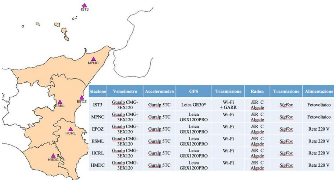
**Figura 1** Mappa delle stazioni OE implementate nell'ambito del progetto "S.O.I.R. monitoraggio futuro" e tabella della sensoristica e degli altri apparati presenti nei siti. Il ricevitore GPS è stato installato presso i vicini locali del Centro Operativo Avanzato della Protezione Civile.
