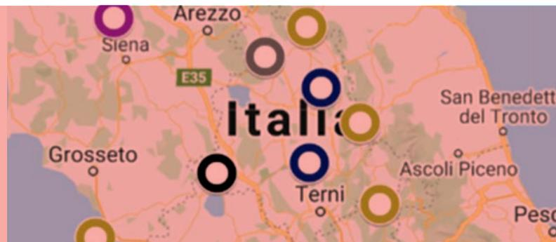
Il progetto “S.O.I.R. monitoraggio futuro” si è posto l’obiettivo di realizzare una rete multiparametrica a scala nazionale caratterizzata dalla presenza, nello stesso luogo, di sensori di varia tipologia: velocimetro, accelerometro, GPS e rilevatore radon, alimentati e/o trasmessi in modo integrato.
