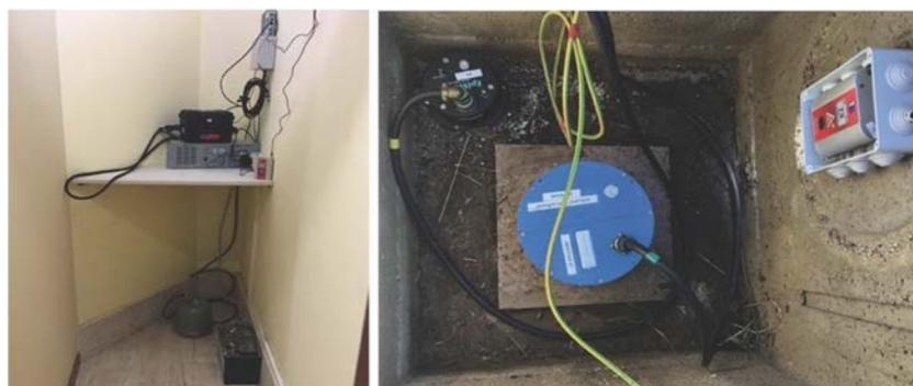
**Figura 3** A sinistra: CMDO, collocata con l'omonima stazione della RSN in un locale seminterrato. Lo strumento è un AER C dell'Algade alimentato a corrente. A destra: ISPIC, collocata con l'omonima stazione della RSN in un pozzetto. Lo strumento è AER C alimentato a batteria interna. SRES (ved. Farroni et al., [2020]).
