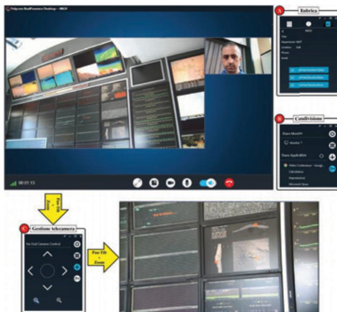
**Figura 3** Interfaccia di *Polycom RealPresence* e dettaglio delle principali funzionalità: a) rubrica con link diretto alle Sale Operative; b) strumenti di condivisione; c) controllo della telecamera remota.
