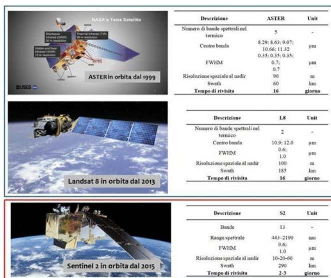
**Figura 1** Principali caratteristiche dei sensori. Nel riquadro blu sono riportate le caratteristiche per i sensori che producono le mappe di temperatura superficiale, nel riquadro rosso le caratteristiche di Sentinel 2 per la mappatura delle colate laviche durante una eruzione.
