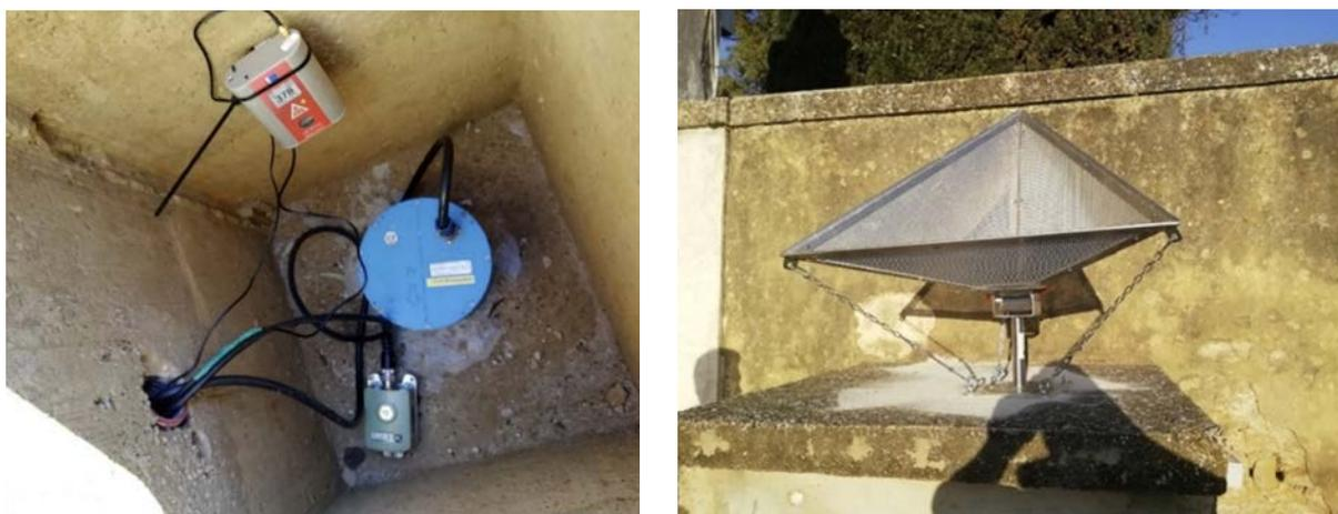
**Figura 2** Esempio di stazione multiparametrica (ACATE): a sinistra è visibile il pozzetto in cemento che ospita un velocimetro, un accelerometro e un radonometro, mentre a destra è ripreso *corner reflector* per applicazioni SAR. La struttura è formata da una base di sostegno in acciaio inox e da un triedro in alluminio perforato, orientabile in funzione della traiettoria di passaggio del satellite.
