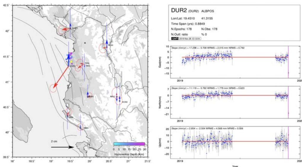
**Figura 2** (sinistra) Mappa del campo di spostamento cosismico osservato alle stazioni GNSS della rete ALBPOS; (destra) Esempio di serie temporale con *offset* cosismico per la stazione DUR2 (Durazzo).
