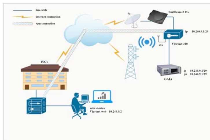
Figura 1 Architettura rete stazione sismica – centrale.
